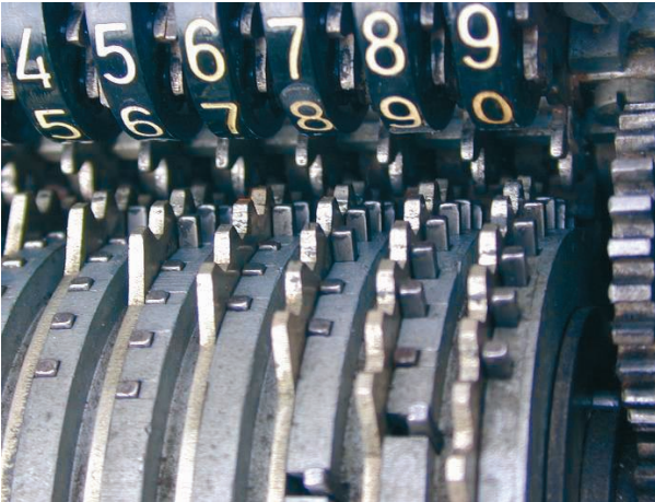
Abb. 20: Original Odhner Modell 139, Blick auf die Sprossenräder: die ausgefahrenen Zähne (Stifte) sind deutlich zu erkennen.
