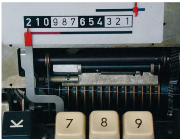
Abb. 32: Blick auf die Kommaanzeige und die zwölf Sprossenräder: es sind jeweils zwei Sprossen zu erkennen
