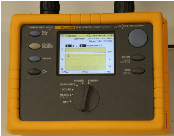
Abb. 1: Das Messgerät, das zur Überwachung der Stromnetzqualität eingesetzt wurde: der Power Logger 1735 der Firma Fluke
